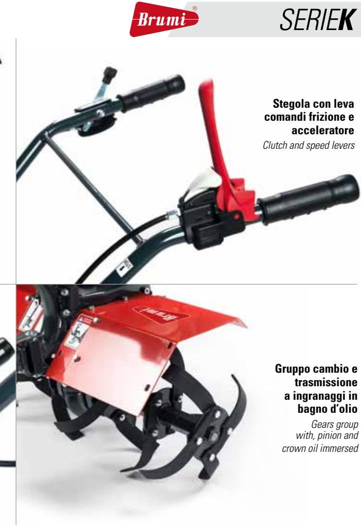
Gruppo cambio e trasmissione a ingranaggi in bagno d'olio
